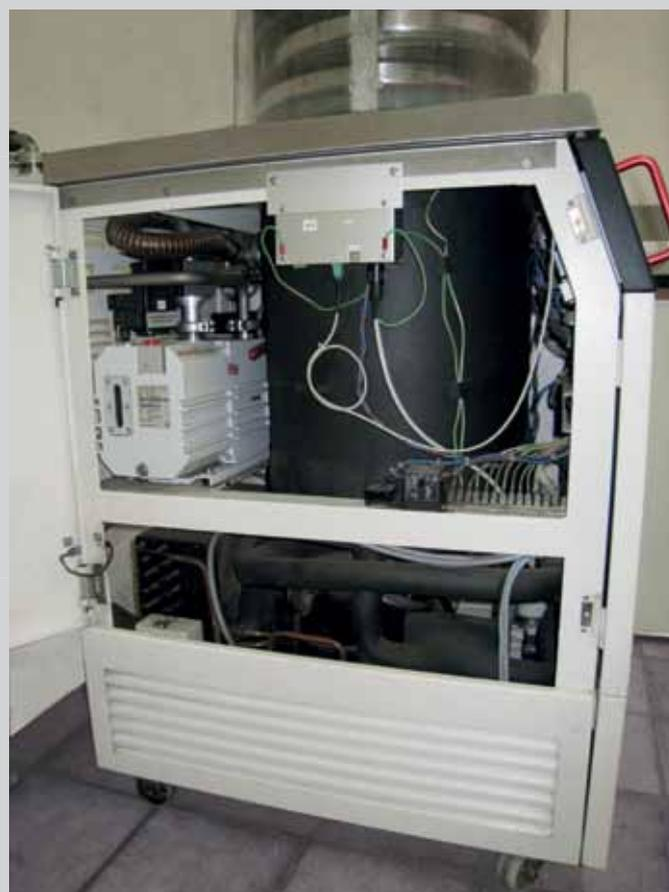
图3：冷冻干燥设备中的普发真空Duo 10 M 旋片泵
