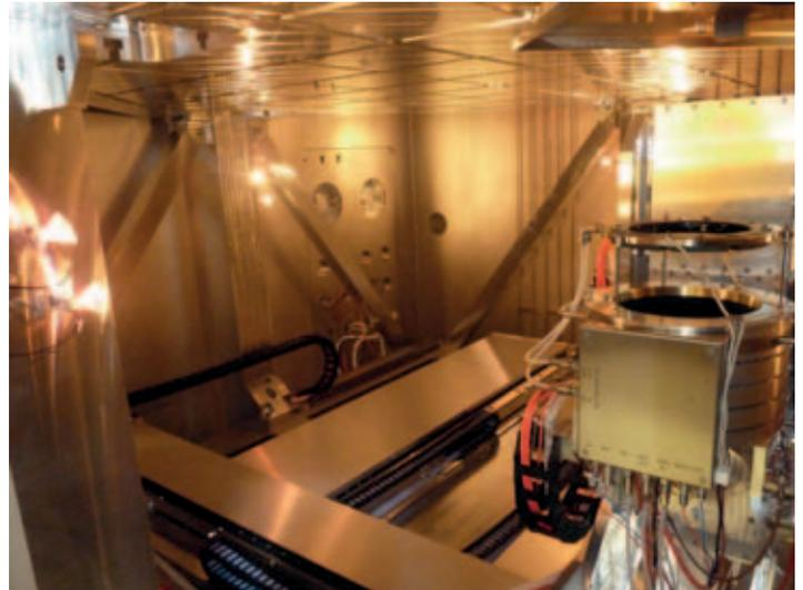
图 2：在 IBF-2000 腔室内使用三轴操作器系统，可加工直径达 2,000 mm 的工件
