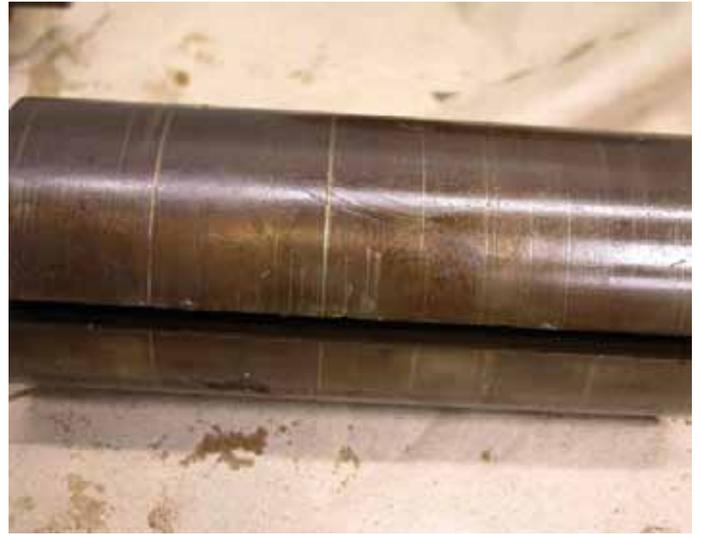
图 3 和图 4：不带滤尘器的旋片式真空泵进气口。转子在气缸中受损。必须更换泵系统
