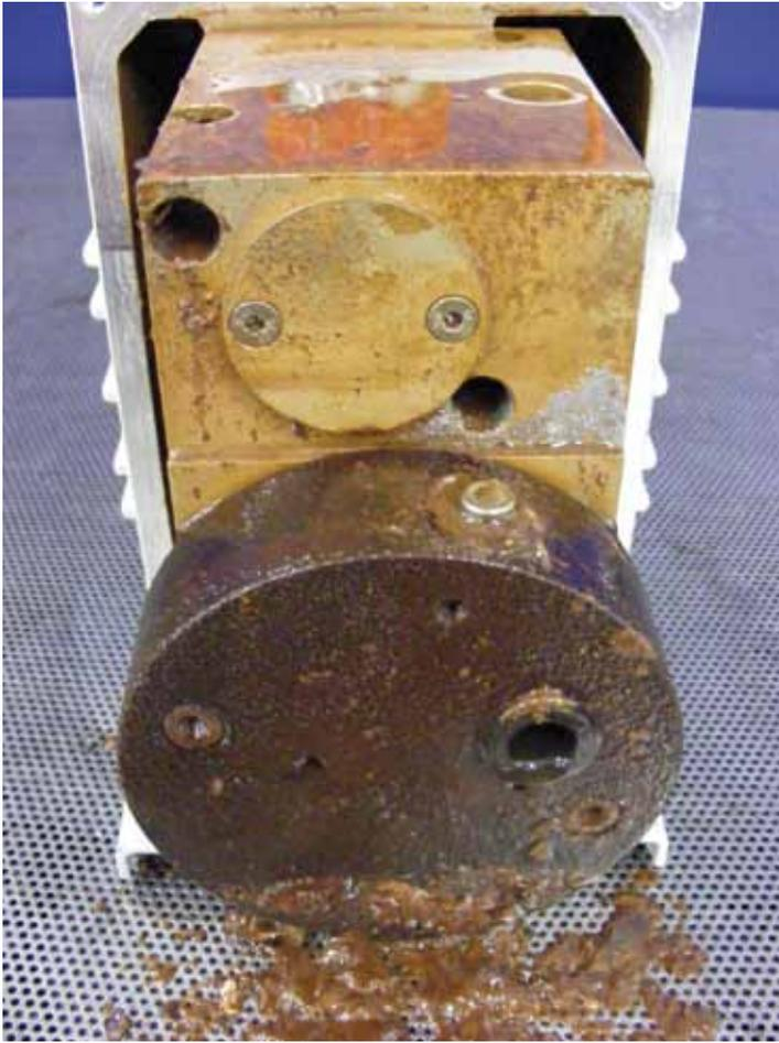
图 1：由于在操作过程中没有使用气震阀导致旋片式真空泵受到严重腐蚀。
