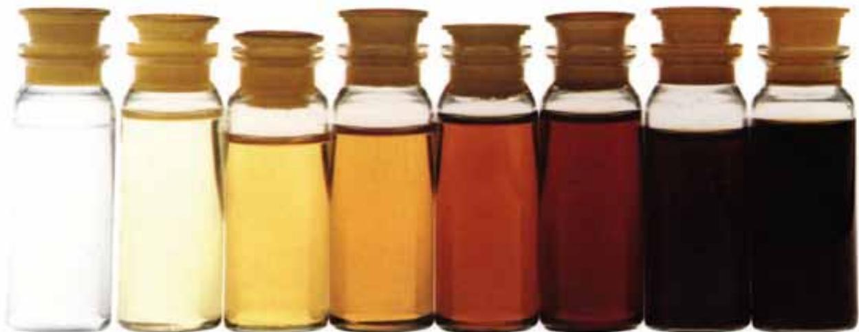
图 2：随着矿物油工作液的老化而发生的颜色变化范围。
